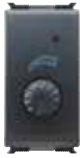
GW 30 403 ▲ Ohmsch 230 V ac 100-900 W Ohmsch 110 V ac 100-500 W Induktiv 230V ac 40-300VA Induktiv 110V ac 20-150VA
