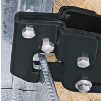
Das Stempelwerkzeug wird durch die Profilbleche gedrückt
