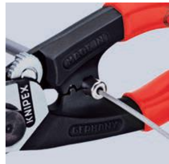
Anpressen der Endhülse an die Bowdenhülle
