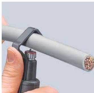
Ansetzen des Werkzeugs für Umfangsschnitt
