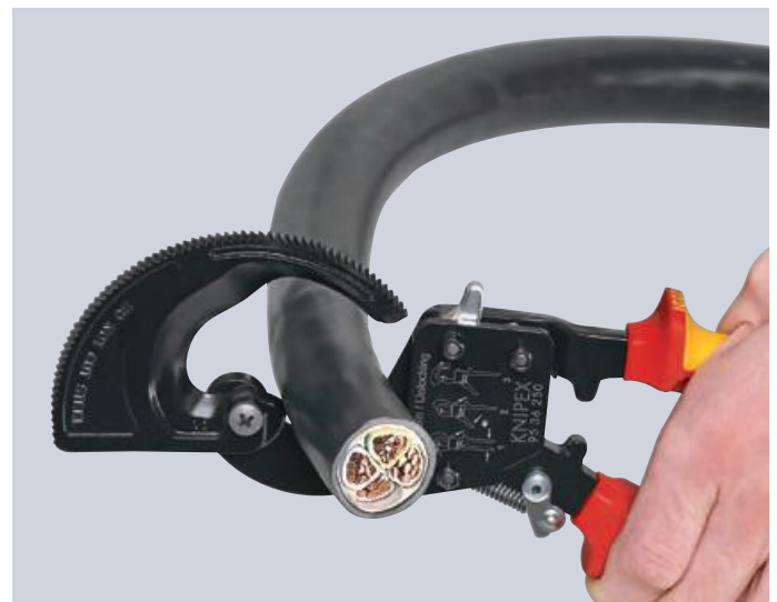
Ratschenprinzip und Zweigang-Zahnkranz-antrieb für kraftsparendes Schneiden
