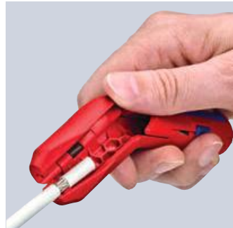
Abmanteln eines Koaxialkabels
