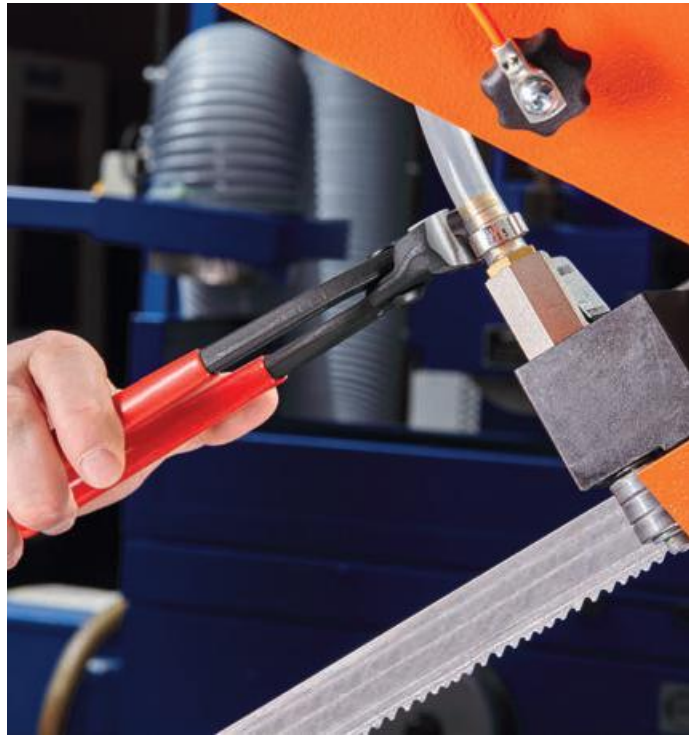
Abdichten Fluidschlauch an Stutzen mittels Seiten-Pressnase
