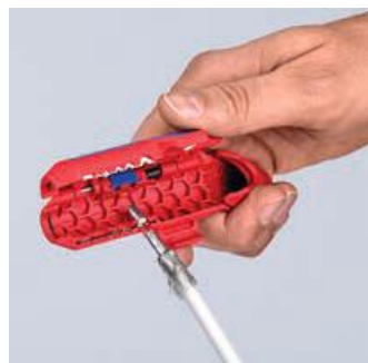
Abisolieren eines Koaxialkabels
