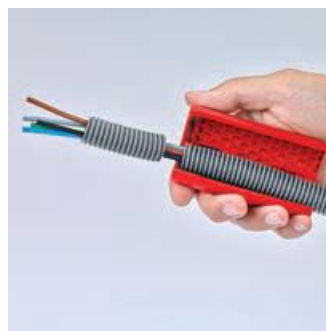
Saubere Schnittkante und keine Beschädigung der innen liegenden Kabel, da der Schnitt immer oben auf der Welle erfolgt
