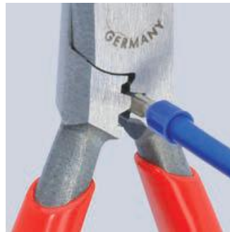
Crimpen 0,5 bis 2,5 mm 2
