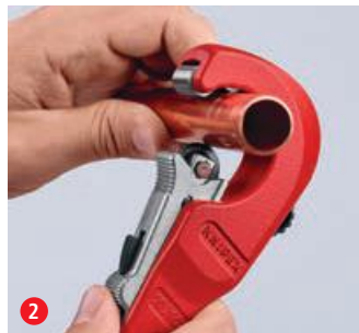
Schneidrad mit QuickLock-Einhandschnellverstellung ans Rohr schieben: schnelle Einstellung an unterschiedliche Rohrdurchmesser
