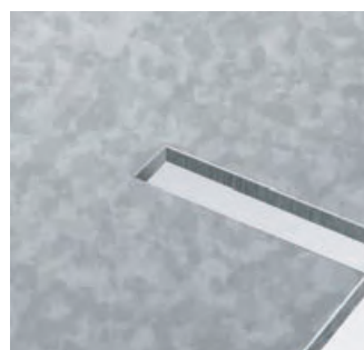
Ausklinken und Spanbrechen in einem Arbeitsgang
