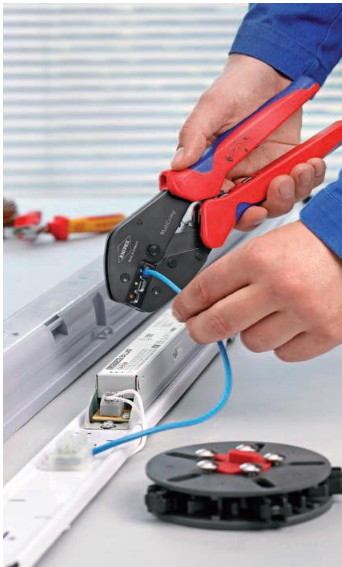
Magazin für Crimpeinsätze kann am Gürtel getragen werden
