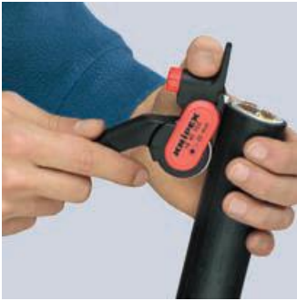
Ansetzen des Werkzeugs für Längsschnitt
