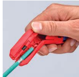
Abmanteln eines Datenkabels
