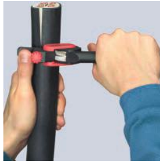
Drehen des Werkzeugs für Umfangsschnitt
