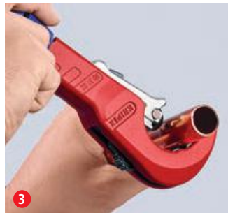
Durch Drehung schneiden und dabei mit dem ergonomischen blauen Drehknauf nachstellen ...
