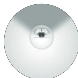
Rückwärtiger Lichtanteil zur Deckenaufhellung.
