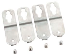
Außenbefestigungslaschen, zur Montage einzelner Gehäuse an ebenen Wandflächen, kann am Unterkasten im Winkel 0°, 45° oder 90° befestigt werden, Wandabstand 7 mm, Material Edelstahl, geeignet für AKL / AKi-L Leergehäuse, AKi Schalter- und Sicherungsgehäuse, AKi Steckdosenverteiler, AKi-Z / ZVi Zählergehäuse
