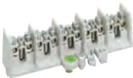
Hauptleitungsabzweigklemme mit Anschlussquerschnitt 1 x 35 mm<sup>2</sup> je Pol und 2 Abgängen 25 mm<sup>2</sup> je Pol
