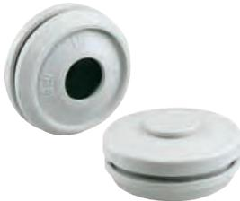
Doppelmembranstutzen mit zwei Dichtungsmembranen, geschlossen, thermoplastisches Elastomer (TPE), grau, für Wandstärken 1,5 - 4,5 mm
