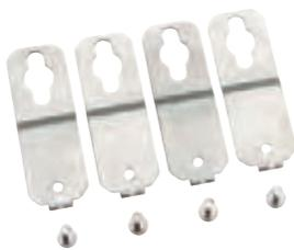
Außenbefestigungslaschen, zur Montage einzelner Gehäuse an ebenen Wandflächen, kann am Unterkasten im Winkel 0°, 45° oder 90° befestigt werden, Wandabstand 7 mm, Material Edelstahl, geeignet für AKL / AKi-L Leergehäuse, AKi Schalter- und Sicherungsgehäuse, AKi Steckdosensverteiler, AKi-Z / ZVi Zählergehäuse
