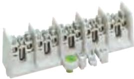
Hauptleitungsabzweigklemme mit Anschlussquerschnitt 1x25 mm<sup>2</sup> je Pol und 2 Abgängen 16 mm<sup>2</sup> je Pol
