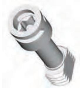
Deckelschrauben-Set (Set = 12 Stück) mit Kopf Innensechsrund T40 gegen das unbefugte Öffnen der Gehäuse, zusätzlich plombierbar, Sonderschraubendreher TK SDR T40 (195 018 01) erforderlich, nutzbar ab TK PS/PC 77 (außer TK 1005)
