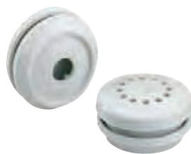
Belüftungsstopfen mit Labyrinthdichtung zur Vermeidung von Kondenswasserbildung in Gehäusen, Durchfluss 100l/min. bei 0,1 bar Überdruck, thermoplastisches Elastomer, grau, empfohlene Montage an den Gehäuseseiten links und rechts in verschiedenen Höhen (siehe Technischer Anhang - Schutz gegen Kondenswasser), für Wandstärken 1,5 - 4,5 mm
