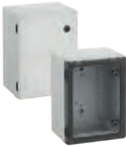
Schaltschrank - Industrie Qualität, geeignet für die Installation in rauen Umgebungen und im ungeschützten Außenbereich, Kasten und Rahmen: glasfaserverstärktes Polycarbonat, grau, ähnlich RAL 7035, Tür: Polycarbonat.
