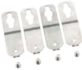
Außenbefestigungslaschen, zur Montage einzelner Gehäuse an ebenen Wandflächen, kann am Unterkasten im Winkel 0°, 45° oder 90° befestigt werden, Wandabstand 7 mm, Material Edelstahl, geeignet für AKL / AKi-L Leergehäuse, AKi Schalter- und Sicherungsgehäuse, AKi Steckdosenverteiler, AKi-Z / ZVi Zählergehäuse
