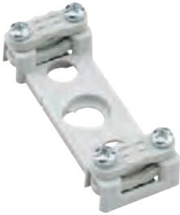
Zugentlastung, zur Montage in 2K-12 / 2K-16-Verbindungsdozen, Zugentlastung von bis zu 2 Einführungen möglich, Zugentlastung kann werkzeuglos geteilt werden, für eine T-Verdrahtung werden 2 Zugentlastungslaschen benötigt
