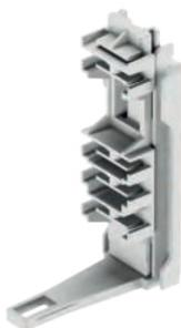
Montagehalter-Set, zur werkzeuglosen Montage von Normschiene 35 x 7,5 mm und Montageplatten in unterschiedlichen Höhen, zusätzliche obere Position für die Montage von Reiheneinbaugeräten in Verbindung mit Klappfenstern im Deckel von Leergehäusen, Set = 4 Stück
