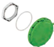
BEL Air Belüftungselemente-Set, zur Vermeidung von Kondenswasserbildung in Gehäusen, zum senkrechten Einbau in Gehäusewände und GFL Kombiflansche mit entsprechender Vorprägung, pro Gehäuse sind mindestens zwei Belüftungselemente erforderlich
