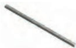
Stützholme für verschiedene Wandstärken bei Gegenschalung, Einsatz immer in Verbindung mit Blindsockel oder Gegendose, Holmlänge=Wandstärke minus 1 cm, 2 Stützholme je Dose, 4 Stützholme bei extremer Belastung
