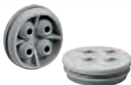
Doppelmembranstutzen mit zwei Dichtungsmembranen, geschlossen, max. vier Leitungseinführungen für Steuerleitungen, thermoplastisches Elastomer (TPE), grau, für Wandstärken 1,5 - 4,5 mm
