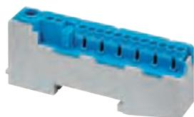
Klemme, für starre Leiter, 15 Klemmstellen, 1x schraubbare Klemmstelle 25 mm<sup>2</sup>, 2x schraubenlose Klemmstelle 4 mm<sup>2</sup>, 12x schraubenlose Klemmstellen 2,5 mm<sup>2</sup>, zur Montage auf DIN Tragschienen 35 mm, bei einer Strombelastbarkeit von 76 A
