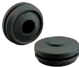
Doppelmembranstutzen mit zwei Dichtungsmembranen, geschlossen, thermoplastisches Elastomer (TPE), schwarz, für Wandstärken 1,5 - 4,5 mm,
