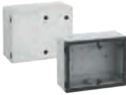
Schaltschrank - Industrie Qualität, geeignet für die Installation in rauen Umgebungen und im ungeschützten Außenbereich, Kasten und Rahmen: glasfaserverstärktes Polycarbonat, grau, ähnlich RAL 7035, Tür: Polycarbonat.
