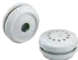
Belüftungsstopfen mit Labyrinthdichtung zur Vermeidung von Kondenswasserbildung in Gehäusen, Durchfluss 100l/min. bei 0,1 bar Überdruck, thermoplastisches Elastomer, grau, empfohlene Montage an den Gehäuseseiten links und rechts in verschiedenen Höhen (siehe Technischer Anhang - Schutz gegen Kondenswasser), für Wandstärken 1,5 - 4,5 mm
