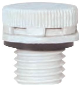
Druckausgleichselement mit luftdurchlässiger und wasserdichter Spezialmembranfolie zur Vermeidung von Kondenswasserbildung in Gehäusen, Durchfluss 0,8l/min. bei 0,1 bar Überdruck, Polyamid, grau
