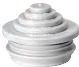
Stufennippel mit geschlossener Dichtungsmembran, abschneidbar in mehreren Stufen, thermoplastisches Elastomer (TPE), grau, für Wandstärken von 1,5 - 4,0 mm
