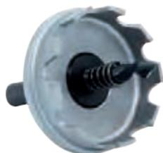
Lochfräser für Hand- und Säulenbohrmaschinen, hochwertige Industrierausführung mit Hartmetallschneideplatten für hohe Schnittleistung, mit Zentrierbohrer (auswechselbar) und Auswurffeder
