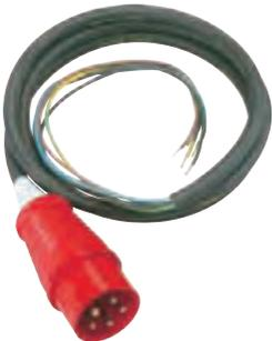
Zuleitungsgarnitur für Steckdosenkombinationen bis 16 A, 2 m Leitung HO7RN-F 5G2,5
