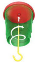
Metallmutter M5 – Sichere Aufnahme von Leuchtenhaken nach DIN EN 60670 bis 100 N (10 kg).
