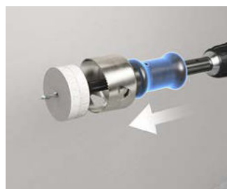
Bohrkern mittels Schiebegriff herausschieben und entnehmen.
