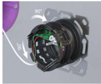
Optional Faserjustierung durch drehen vornehmen.
