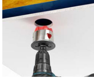
Zur Vergrößerung bestehender Einbauöffnungen von Ø 68 mm auf Ø 74 mm Zentriereinsatz (Art.-Nr. 1083-99) verwenden.
