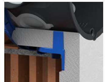
Der Putz dringt bis zum Lamellenring ein und sorgt so für die sichere und dauerhafte Befestigung der Dose.
