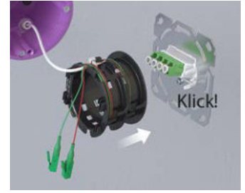
Fasermanagement Trommel mit dem Tragring verrasten.
