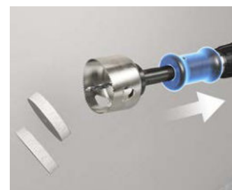
Schiebegriff in Ausgangsposition zurück schieben.
