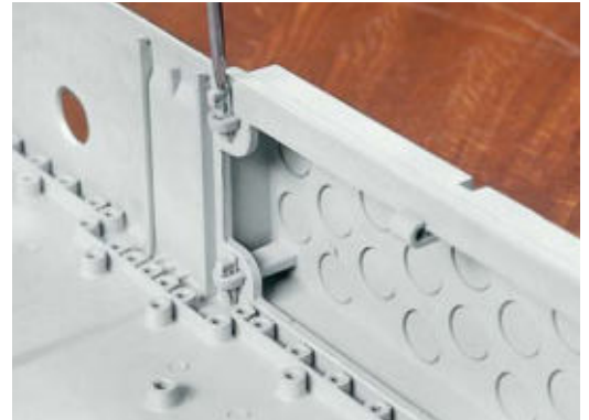
Anbauflansche (Mi) Anbauflansche mit unterschiedlichen Vorprägungen oder elastischen Dichtmembranen können -auch nachträglich- an jede Gehäusewand über Keilverbindungen montiert werden.
