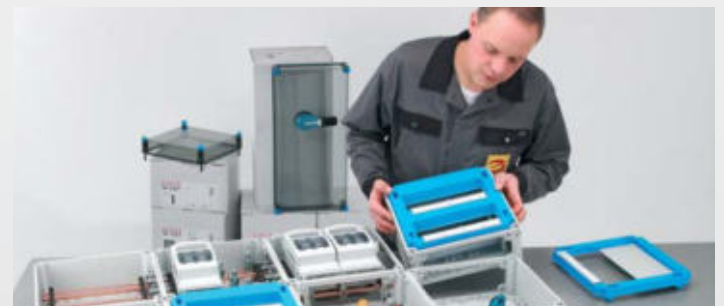
Mi-Verteiler bauen nach DIN EN 61439-2
