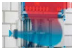
Belüftung über Belüftungsflansch oder Belüftungseinsatz
