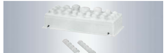
Anbauflansche (Mi) Anbauflansche mit unterschiedlichen Vorprägungen oder elastischen Dichtmembranen können -auch nachträglich- an jede Gehäusewand über Keilverbindungen montiert werden.
