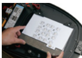
Werkzeuglos tauschbares LED-Modul
