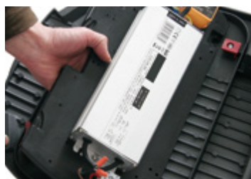
Werkzeuglos tauschbares LED-Vorschaltgerät
