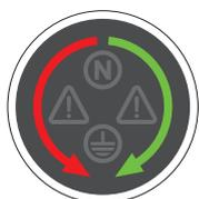
Bei gleichzeitigem Aufleuchten von „Drehfeld links“ und „Drehfeld rechts“ (in jeglicher Kombination mit den anderen Symbolen) sind Fehler bzw. Fehlerkombinationen vorhanden, welche durch eine Elektrofachkraft zu überprüfen sind.
