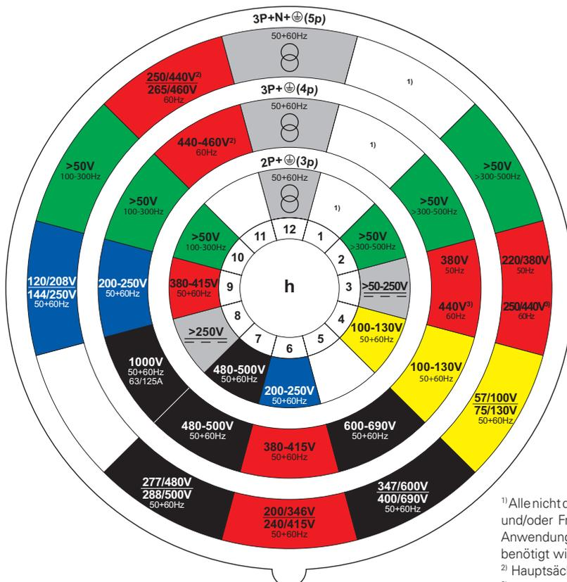
Uhrzeitstellung des Erdkontaktes von der Frontseite der Steckdose oder Kupplung gesehen.
