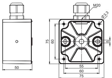
Robuste Aufputzdose aus PA6 für Anbaudosen in IP67 mit einem Flanschmaß von 75x75mm.
