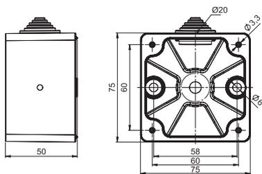
Robuste Aufputzdose aus PA6 für Anbaudosen in IP44 mit einem Flanschmaß von 75x75mm.
