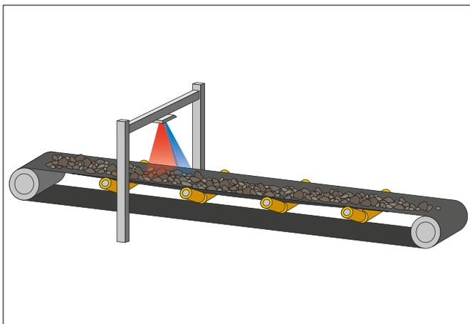
Der Radarsensor erfasst Beladungshöhe und Geschwindigkeit eines Förderbands.
