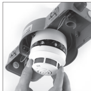
Rauchschartertechnik im Inneren des LRS
