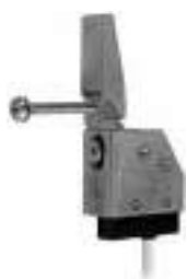
Riegelschaltkontakt Modell 878 Riegelschaltkontakte sind zur Überwachung der Verriegelung von Türen geeignet. Durch den drehbar gelagerten Schalthebel ist keine Begrenzung des Riegeleinschlusses vorhanden. Die schmale Bauform sowie die mitgelieferte Montageschraube erlauben es, auch in vorhandene Stahlzargen ohne Schließblech durch den ausgestanzten Riegelausschnitt montiert werden kann. Dies kann auch nachträglich bei schon eingebauten Zargen erfolgen.
