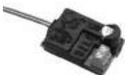
Vorlastelektronik 760-12 Verbessert die Vorlasteigenschaft bei Gleichstrombetrieb auf min. 300N. Ein kurzes Brummgeräusch am Türöffner wird ca. 0,5 Sekunden lang hörbar. Dauerstromfest, Haltestrom wird reduziert. Kompatibel zu gängigen effeff-Türöffnern.
