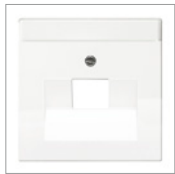
Zentralscheibe 1) Als Abdeckung für UAE-Anschlussdosen. Art.-Nr. 0213 (Kategorie 3/ISDN), 0216-101, 0218/11-101 (Kategorie 5e/6 Datentechnik) und vergleichbare Typen der Firma Rutenbeck. Für WLAN-Accesspoints 8186/31 und 8186/41. Brand-Rex (WAEGV 8 EKR/EK). BTR (UAE design und IAE design). Telegärtner (AMJ 45, UMJ 45). Mit Schräguslass. Mit Beschriftungsfeld. Größe des Beschriftungsfeldes: 60 x 9 mm. Schutzart Gerät: IP 20
