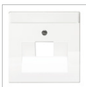
Zentralscheibe 1) Als Abdeckung für UAE-Anschlussdosen. Art.-Nr. 0213 (Kategorie 3/ISDN), 0216-101, 0218/11-101 (Kategorie 5e/6 Datentechnik) und vergleichbare Typen der Firma Rutenbeck. Für WLAN-Accesspoints 8186/31 und 8186/41. Brand-Rex (WAEGV 8 EKR/EK). BTR (UAE design und IAE design). Telegärtner (AMJ 45, UMJ 45). Mit Schrägauslass. Mit Beschriftungsfeld. Größe des Beschriftungsfeldes: 60 x 9 mm. Schutzart Gerät: IP 20
