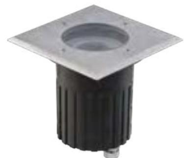
Polyester überzogenes Aluminiumgehäuse mit V2A-Edelstahlblende • \*5,0 Watt Leuchtmittel dimmbar • mit Kunststoff Einbauhülse • 1 x M-Verschraubung • 1,00 m Anschlussleitung (H05RN-F 3 x 0,75 mm<sup>2</sup>) mit freien Aderenden
