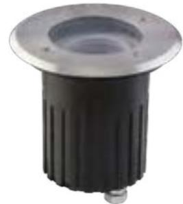
Polyester überzogenes Aluminiumgehäuse mit V2A-Edelstahlblende • \*5,0 Watt Leuchtmittel dimmbar • mit Kunststoff Einbauhülse • 1 x M-Verschraubung • 1,00 m Anschlussleitung (H05RN-F 3 x 0,75 mm<sup>2</sup>) mit freien Aderenden
