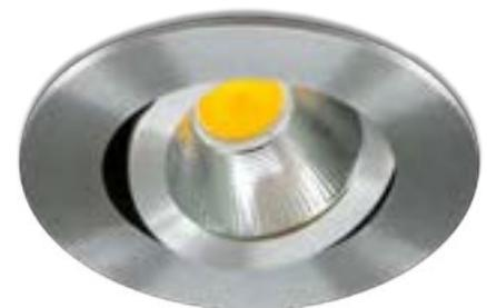
Aluminiumgehäuse • DALI2 • DT6 • L80B10 bei 50.000h • mit externem DALI LED-Netzgerät DALD35009VSAMP (57 x 57 x 24 mm) • 0,30 m Anschlussleitung mit AMP-Stecker • 41 mm Einbautiefe im geschwenkten Zustand • 0,15 m Anschlussleitung mit freien Aderenden (Netzgerät) • optional kurze Haltefedern (Art.-Nr. HFKPC) für Kaiser ThermoX
