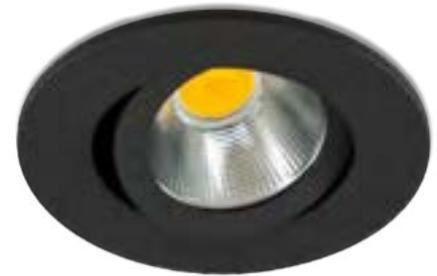
Aluminiumgehäuse • dimmbar über Phasen- und abschnitt • L80B10 bei 50.000h • mit externem LED-Netzgerät PLD109 (48 x 50 x 24 mm) • 0,30 m Anschlussleitung mit AMP-Stecker • 41 mm Einbautiefe im geschwenkten Zustand • 0,15 m Anschlussleitung mit freien Aderenden (Netzgerät) • optional kurze Haltefedern (Art.-Nr. HFKPC) für Kaiser ThermoX • IP65-Ausführung dieser Serie siehe Seite 282–285
