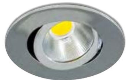
Aluminiumgehäuse • DALI2 • DT6 • L80B10 bei 50.000h • mit externem DALI LED-Netzgerät DALD35009VSAMP (57 x 57 x 24 mm) • 0,30 m Anschlussleitung mit AMP-Stecker • 38 mm Einbautiefe im geschwenkten Zustand • 0,15 m Anschlussleitung mit freien Aderenden (Netzgerät) • optional kurze Haltefedern (Art.-Nr. HFKPC) für Kaiser ThermoX
