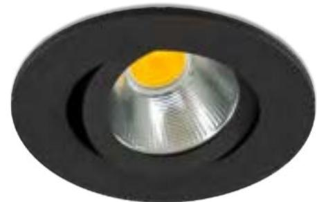
Aluminiumgehäuse • dimmbar über Phasen- und abschnitt • L80B10 bei 50.000h • mit externem LED-Netzgerät PLD109-1A65 (48 x 50 x 24 mm) • 0,30 m Anschlussleitung • optional kurze Haltefedern (Art.-Nr. HFKPC) für Kaiser ThermoX • optional 2,50 m Verlängerungsleitung (Art.-Nr. 0652512-2)
