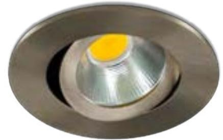
Aluminiumgehäuse • dimmbar über Phasen- und abschnitt • L80B10 bei 50.000h • mit externem LED-Netzgerät PLD109 (48 x 50 x 24 mm) • 0,30 m Anschlussleitung mit AMP-Stecker • 38 mm Einbautiefe im geschwenkten Zustand • 0,15 m Anschlussleitung mit freien Aderenden (Netzgerät) • optional kurze Haltefedern (Art.-Nr. HFKPC) für Kaiser ThermoX • IP65-Ausführung dieser Serie siehe Seite 282–285
