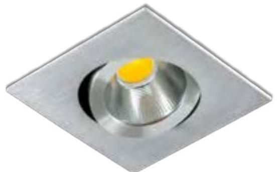
Aluminiumgehäuse • dimmbar über Phasen- und abschnitt • L80B10 bei 50.000h • mit externem LED-Netzgerät PLD109-1A65 (48 x 50 x 24 mm) • 0,30 m Anschlussleitung • optional kurze Haltefedern (Art.-Nr. HFKPC) für Kaiser ThermoX • optional 2,50 m Verlängerungsleitung (Art.-Nr. 0652512-2)
