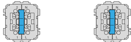
Bild 5: Beleuchtet bei AUS (Orientierungs-Beleuchtung), Kreuzschaltung mit 2 Wechselschaltern beleuchtet, mit Linse, LED-Kontaktingen an den Klemmen 2 - 1
