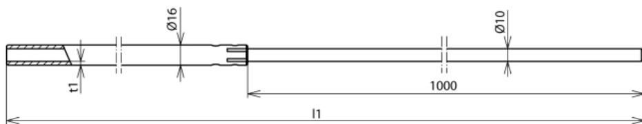
Rohrfangstange mit Verjüngung (1000 mm), leichte Ausführung angefast, zum Schutz von Dachaufbauten, Kaminen usw., speziell für Betonssockel (17 kg) mit Keiltechnik oder für die Befestigung mit Stangenhaltern / Distanzhaltern.
