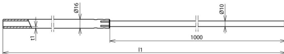
Rohrfangstange mit Verjüngung (1000 mm), leichte Ausführung angefast, zum Schutz von Dachaufbauten, Kaminen usw., speziell für Betonsockel (17 kg) mit Keiltechnik oder für die Befestigung mit Stangenhaltern / Distanzhaltern.
