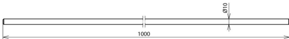
Fangstange beidseitig angefast, zum Schutz von Dachaufbauten, Kaminen usw., auch zum Errichten mit Betonsockel (8,5 kg) mit Keiltechnik, oder für die Befestigung mit Stangenhaltern / Distanzhaltern.
