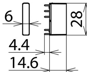
Trennmodul als Ersatzteil zum Einsetzen in DCO SD2 für Signaltrennung im Anlagenkreis.
