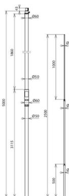
Stützrohr mit innenliegendem Endverschluss und PA-Federelement. Fangstange Ø22 / 16 / 10 mm.
