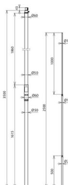
Stützrohr mit innenliegendem Endverschluss und PA-Federelement. Fangstange Ø22 / 16 / 10 mm.
