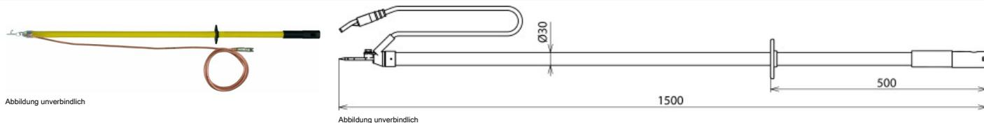
Presskabelschuh PK1 (Bohrung Ø12,5 mm mit Verdrehungsschutz)
