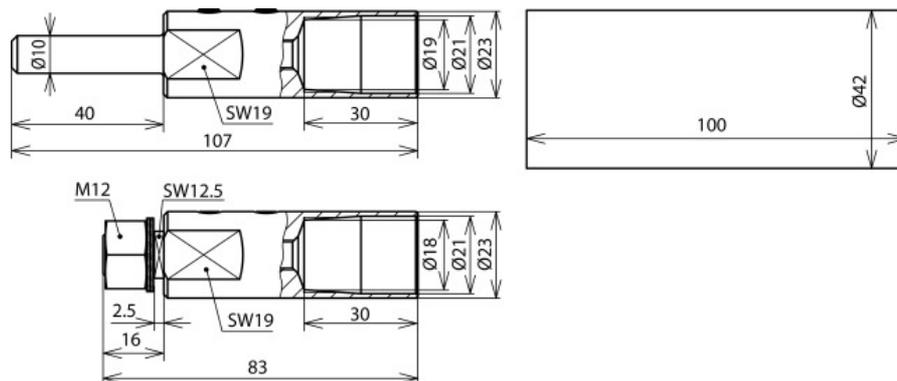
Anschlusselemente zum Abschließen der HVI-long-Leitung an beiden Enden, beim Erstellen des Endverschlusses der Leitung außen am Stützrohr (Kopfstück für Anschlussplatte) und Anschlusselement zum Anschließen an andere Teile des äußeren Blitzschutzes oder der Erdungsanlage (inkl. zwei Schrumpfschläuche und vier Kabelbinder).
