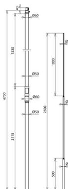
Stützrohr mit innenliegendem Endverschluss und PA-Federelement. Fangstange  $\varnothing 22 / 16 / 10$  mm.
